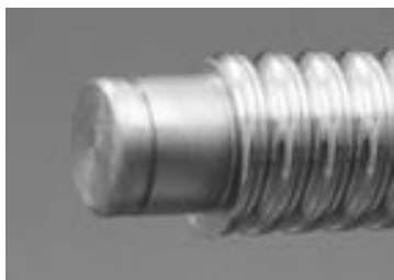
شکل 15 انتهای بال اسکروی ماشینکاری شده برای سمت BF یا FF
