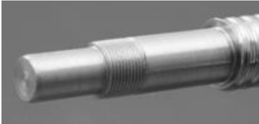
شکل 13 انتهای بال اسکروی ماشینکاری شده برای سمت BK یا FK
